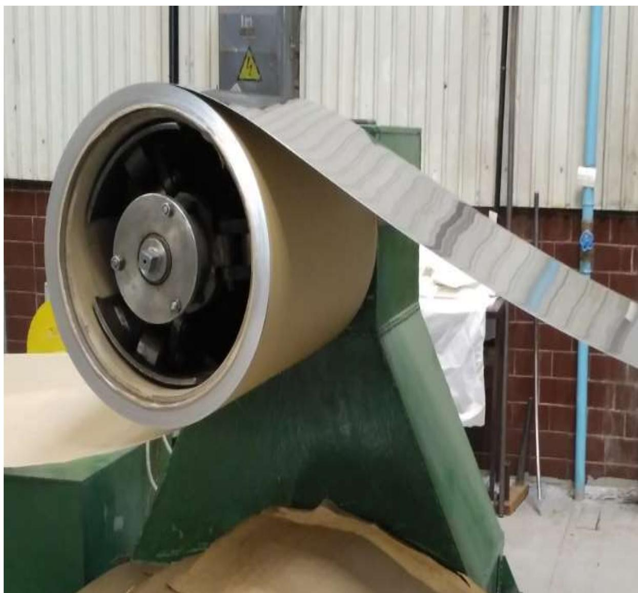
Рисунок 38- разматыватель рулона
